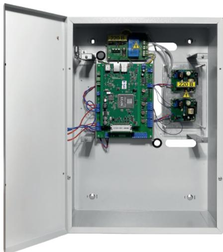
● Контроллер оснащен встроенным источником питания 24В, в корпусе предусмотрено место для установки аккумуляторных батарей АКБ
